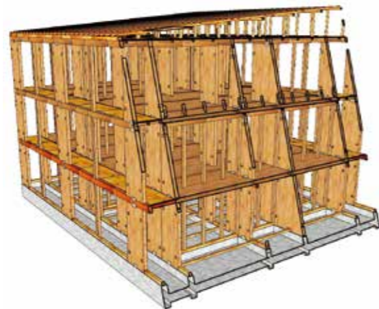
マザーボード割付図(壁用CLT)
