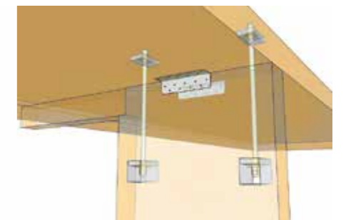
引きボルト、せん断金物 (CLT壁-CLT床)
